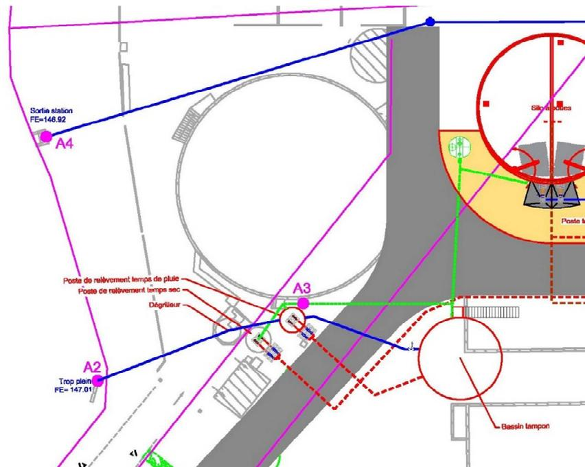
Figure 25: Dégrilleur, postes temps de pluie et temps sec et bassin tampon
